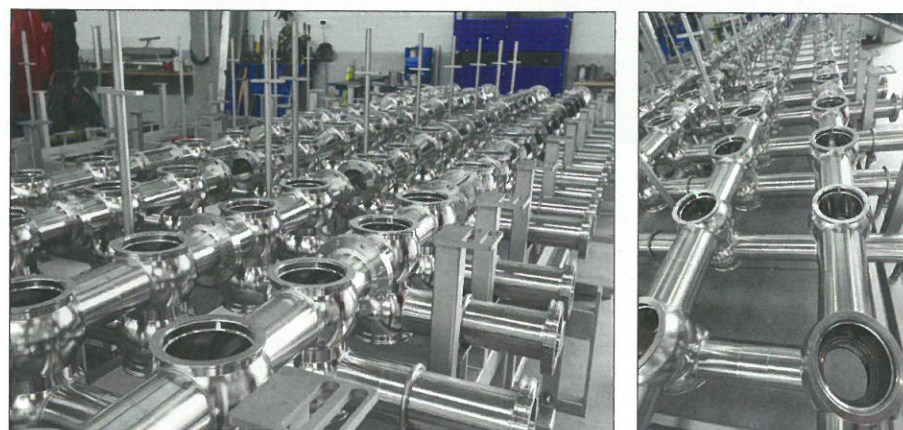
Hochwertige Ventilknoten sind wichtige Bauteile in Produktionsanlagen der Getränkeindustrie. (Bild: Walter Lutz)
